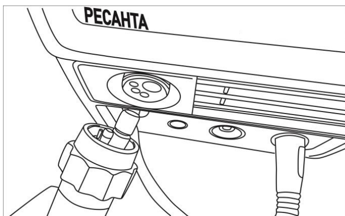
Рис.6 Подключение сварочной горелки к аппарату
